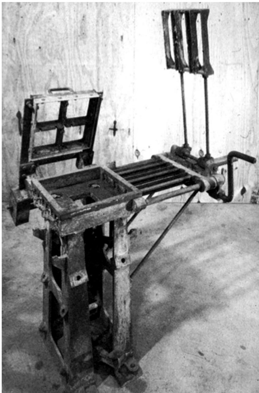
Figura 5. Máquina de producción Knitlock. Fuente: Archivos del Museo de Australia, fotografía de Mati Maldre.
